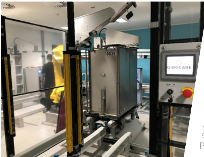
Schrankwagen auf Förderband, Roboter zum automatischer Türöffnung
